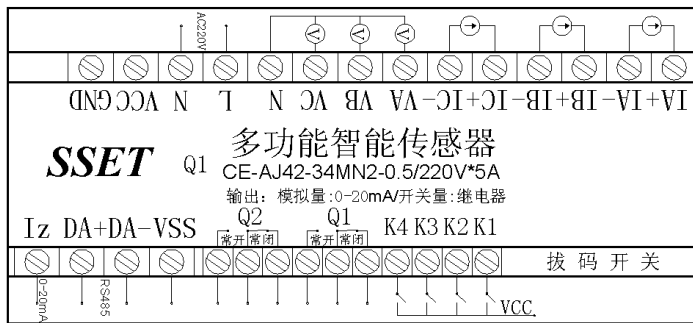
图 3.10.2 三相四线制继电器输出接线参考图
